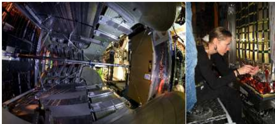
Figure 5: Foto del rivelatore LHCb all'LHC. A sinistra: il magnete per lo spettrometro di LHCb. A destra: Installazione del rivelatore a strip di silicio “made in Zurigo”.
